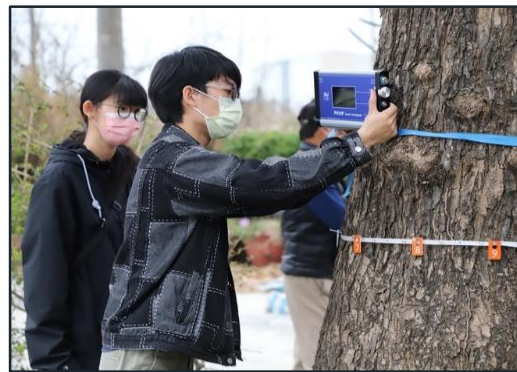
嘉大森林暨自然資源學系學生以應力波斷層掃描圖譜儀檢測好美里老樹樹幹斷面木質部腐朽及密度
