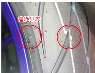
▲ 當胎紋深度到達磨耗界線時應更換輪胎。
