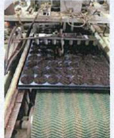
圖1-4 經過第二個感測點即打洞，而後將種子插入穴盤。
