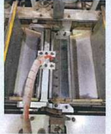
圖1-2 將種子倒入凹槽內，待帶至穴盤經過感測點。
