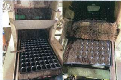
圖1-3 將穴盤放在輸送帶上，經過感測點即倒土並去除多餘的土壤。
