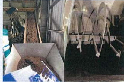
圖1-1 將培養土倒在輸送帶上運進攪拌機裡，攪拌鬆軟預備使用。
