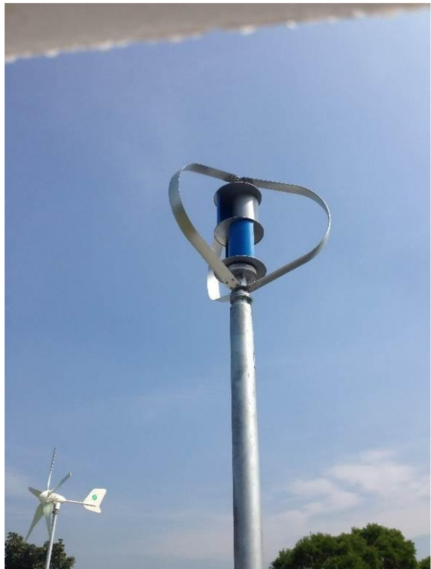
垂直式風力發電機實際照和垂直式風力發電機統教學平台
