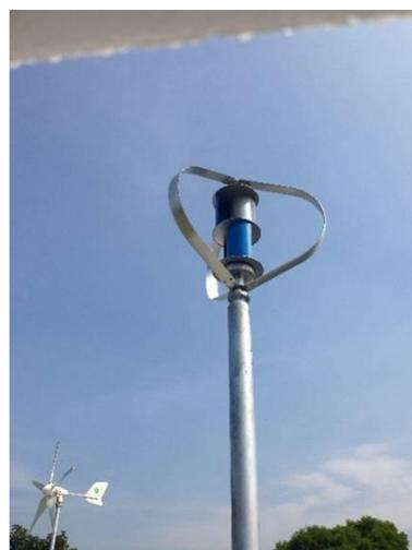
圖 6 300W 垂直軸風力發電機的外觀
