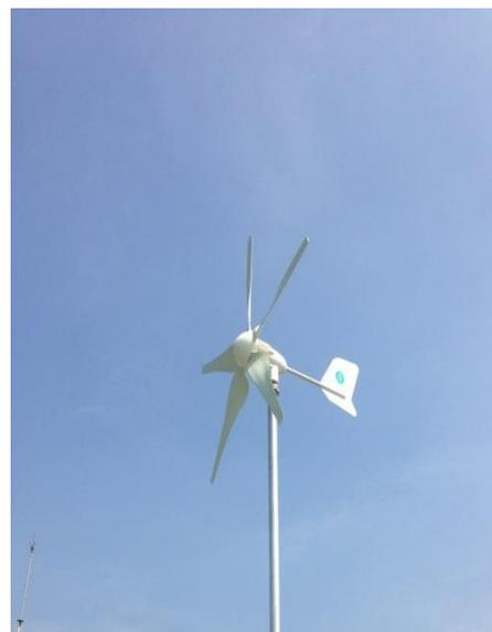
圖 5 400W 水平軸風力發電機實體圖
