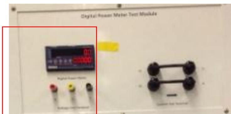
圖 88 開始量測電壓時，須注意電壓表上數值是否歸零，如不為零時，請將電表校正至零點再進行量測。
