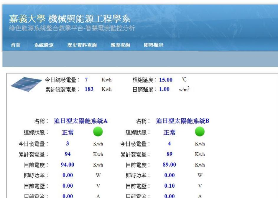
圖 115 太陽能發電機即時顯示之頁面
