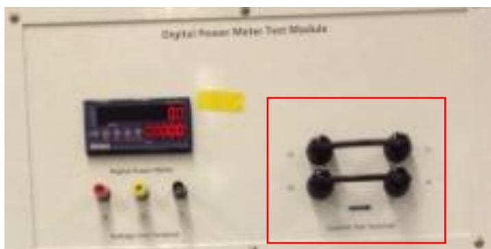
圖 89 開始量測電流時，須注意電流表上數值是否歸零，如不為零時，請將電表校正至零點再進行量測。
