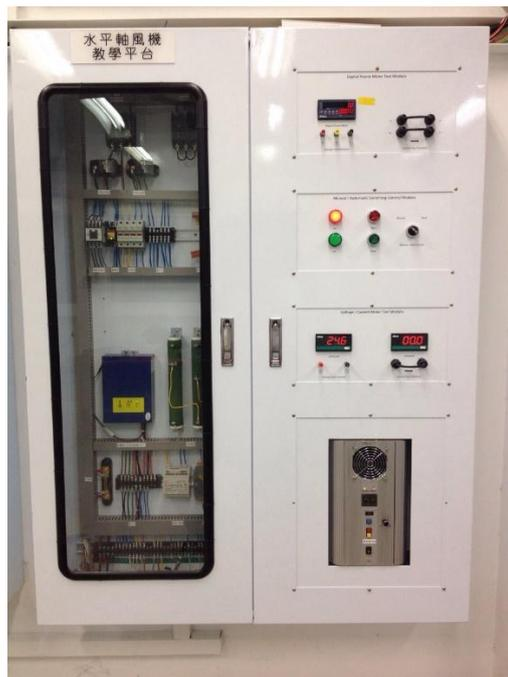
圖 64 水平軸風力發電機實際照和水平軸風力發電機系統教學平台
