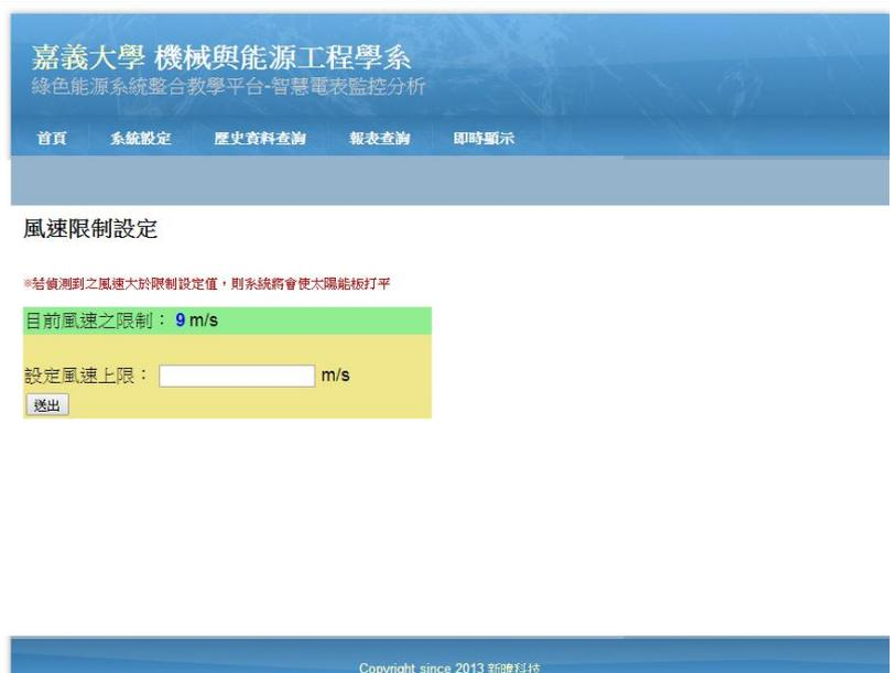
圖 116 模擬風速過大保護功能
