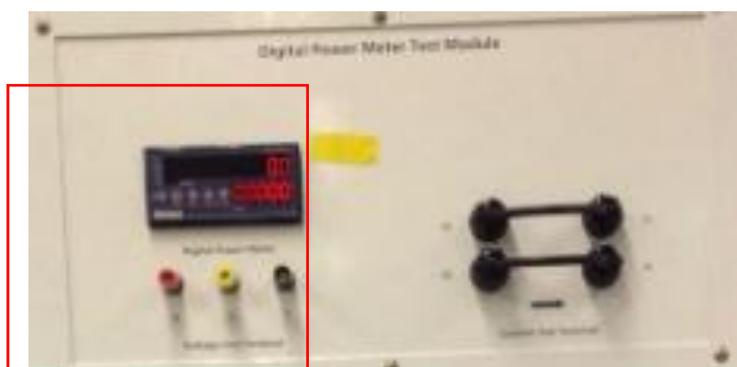
圖 95 開始量測電壓時，須注意電壓表上數值是否歸零，如不為零時，請將電表校正至零點再進行量測。
