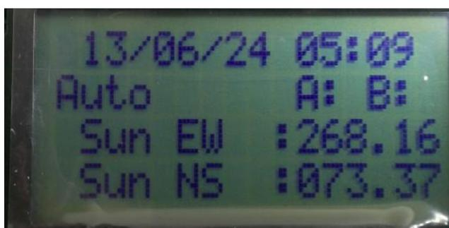
圖43顯示的方位角和仰角為電控板記算的太陽位置角度
