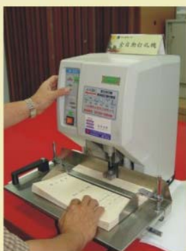
(1) 電動打洞機打孔
