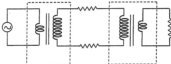
若傳輸線輸送的電功率保持不變，而發電廠變壓器主、副線圈的圈數比，由原來的 3:200 改為 3:100，則傳輸線因熱效應而消耗的電功率，變為原來的多少倍？
