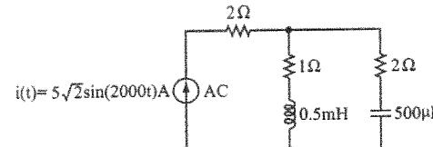
3. 如下圖所示為  $R-L-C$  並聯電路，當電路諧振時，求頻寬 ( $BW$ ) 為何？
