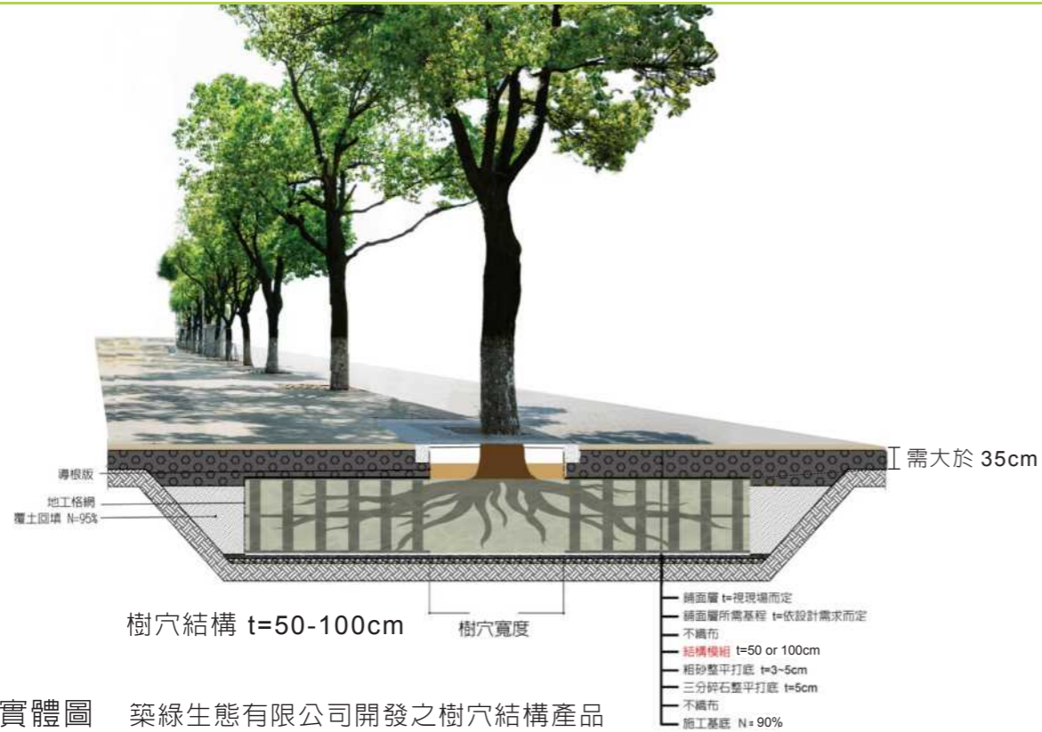
樹穴結構模組示意圖
