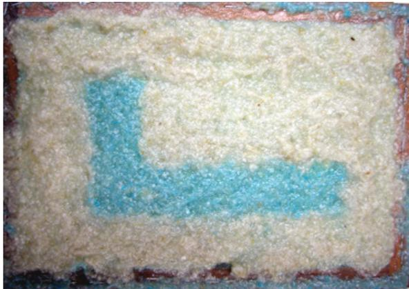
圖十一 L 型字染色紙漿抄製完後淋注再生紙漿
